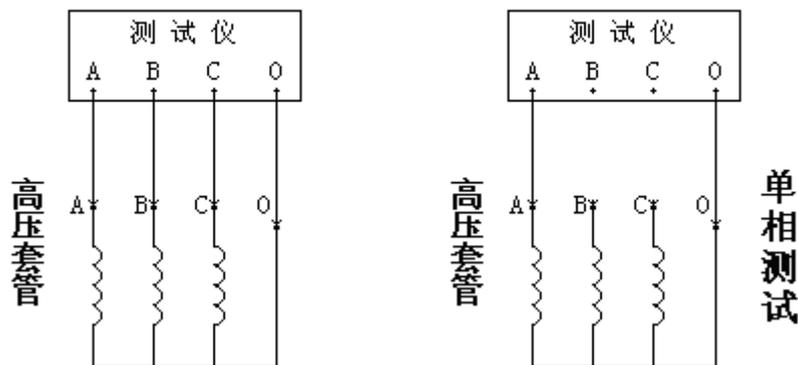
**变压器绕组连接方式 - Y型**
