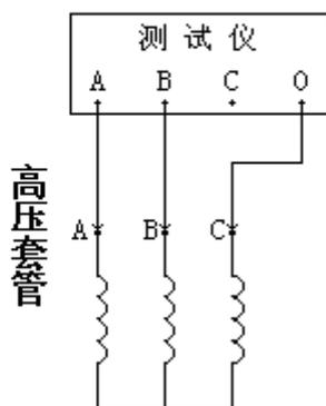
**变压器绕组连接方式 - Δ型**
